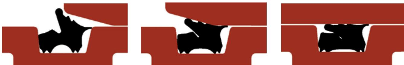
En raison de sa forme particulière, le joint d'étanchéité est fermement positionné dans la gorge. La première lèvre agit ici comme une lèvre d'appui.
