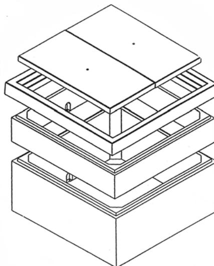
Variante trapon tôle renforcée 250 KN
