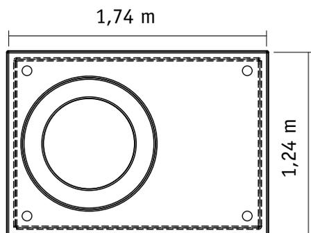
Le levage de chaque élément est assuré par 4 ancres de levage 2,5 T
