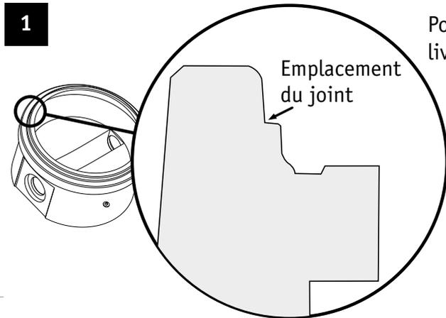
Positionner le joint à lèvre prélubrifié (Forsheda 116) livré avec le regard.
